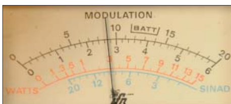
Max modulation 2,7kHz med CTCSS on.
