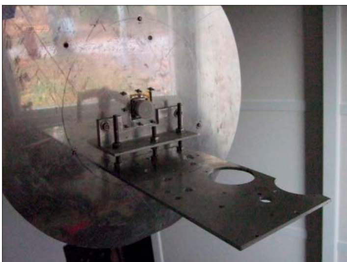
Baksida på reflektorn med monteringsdetaljer och 7/16 koaxkontakt.
