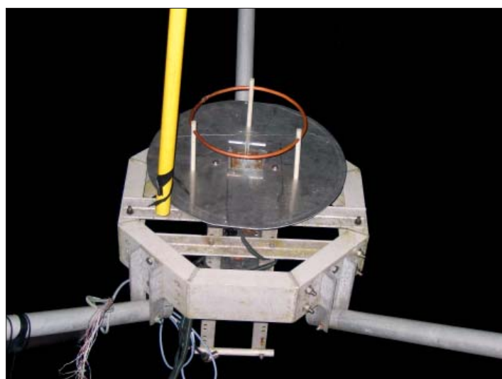
Dipol BRF matare monterad i fokuspunkt. Gult glasfiberör i bild används som indikator på fokuspunkten på 1296 MHz.
